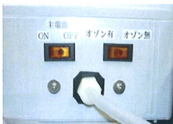
図2 オゾン発生装置スイッチ
